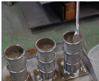
D: 薬さじによる 表面処理
