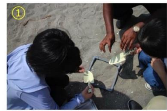
① コドラート枠の中の砂を5cm深度で網カゴに入れる
